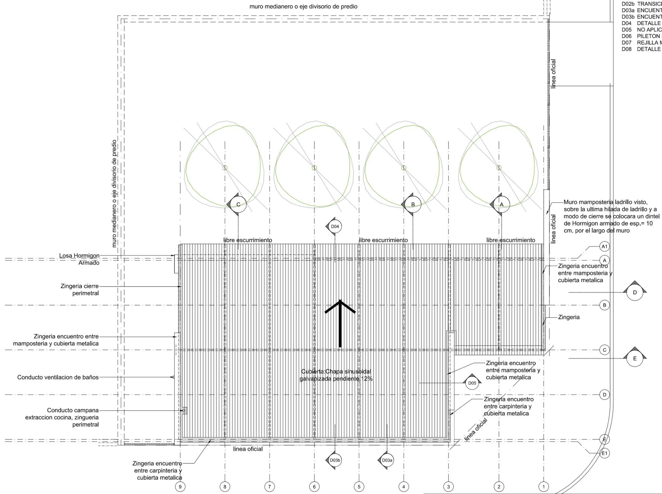
Muro mamposteria ladrillo visto, sobre la ultima hilada de ladrillo y a modo de cierre se colocara un dintel de Hormigon armado de esp.= 10 cm. por el largo del muro
